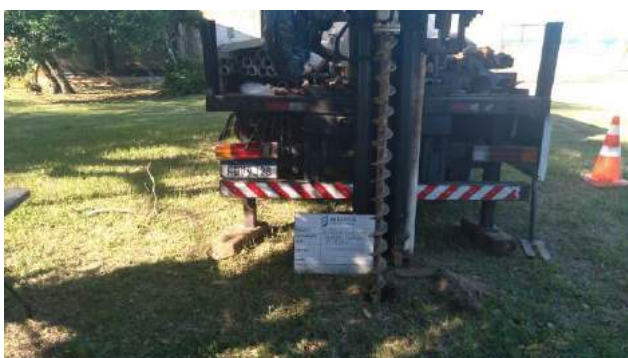
Fotografia 09: Execução da sondagem de reconhecimento ST-02
