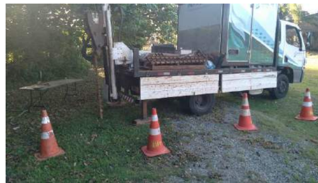
Fotografia 06: Execução da sondagem de reconhecimento ST-04
