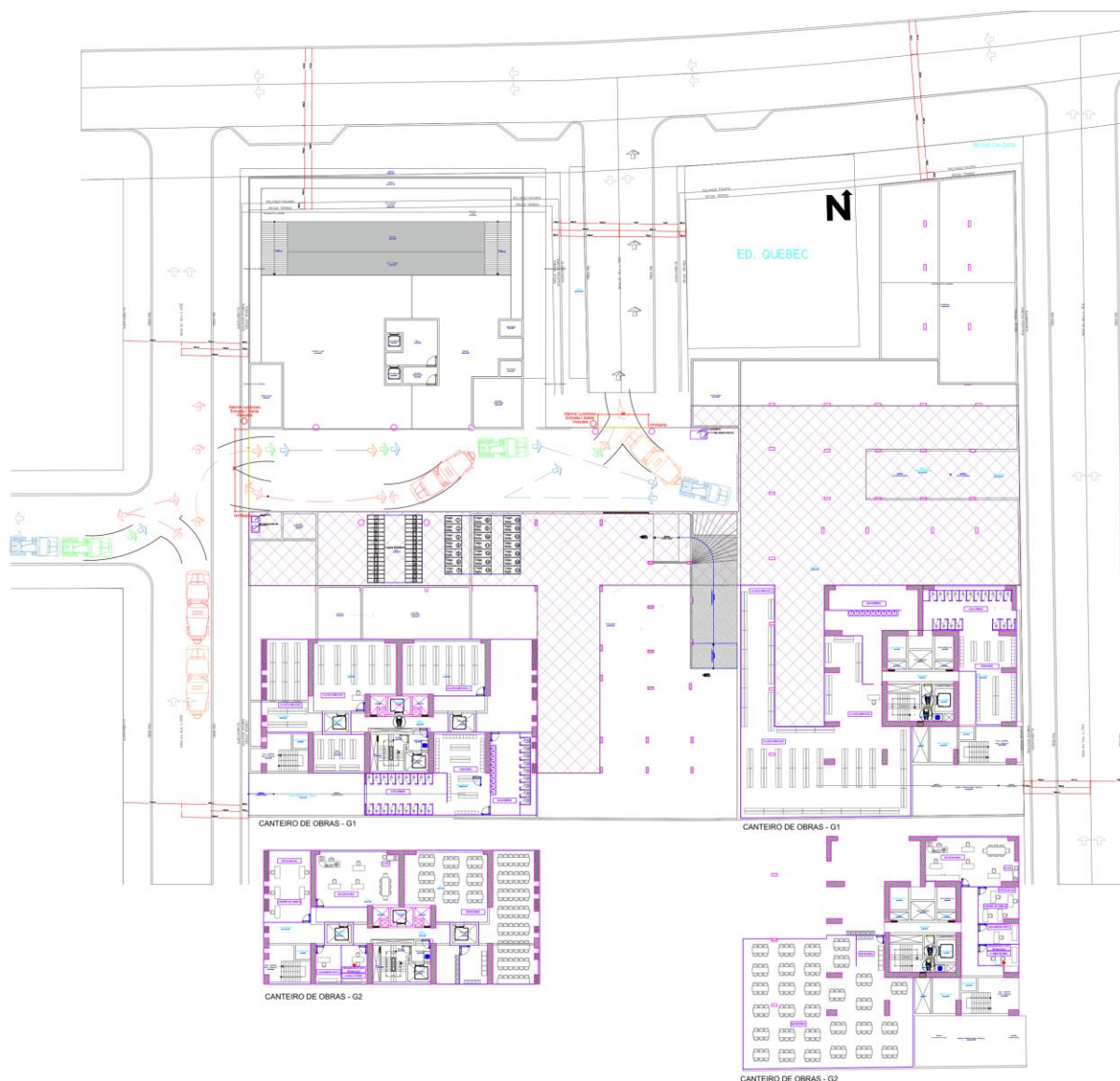
Figura 52. Raio de giro dos caminhões em acordo com manual do DNIT. Fase 2 de implantação.
