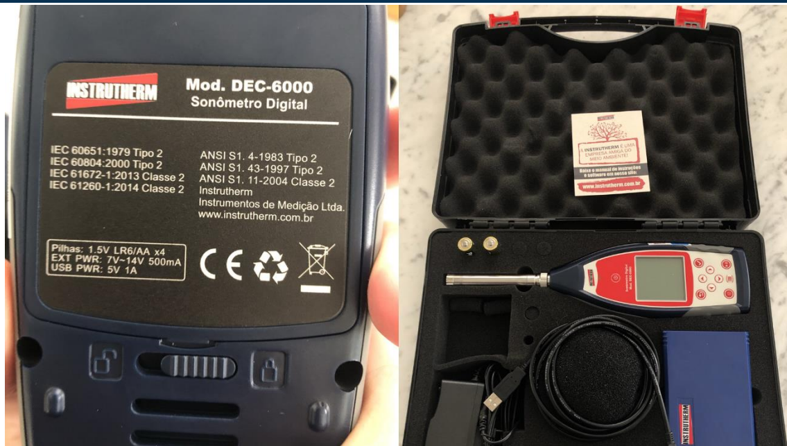
Figura 192. Sonômetro Digital DEC-6000, em atendimento as normas IEC 60651:1979, IEC 60804:2000, IEC 61672-1:2013 Classe 2 e IEC 61260-1:2014 Classe 2, ANSI S1. 4-1983 Tipo 2, ANSI S1. 43-1997 Tipo 2 e ANSI S1. 11-2004 Classe 2.
