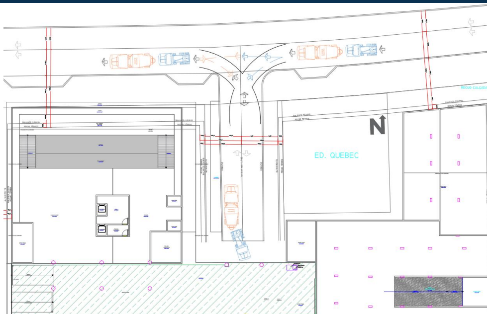
Figura 58. Detalhe para o raio de giro dos caminhões em acordo com manual do DNIT. Fase 3 de implantação
