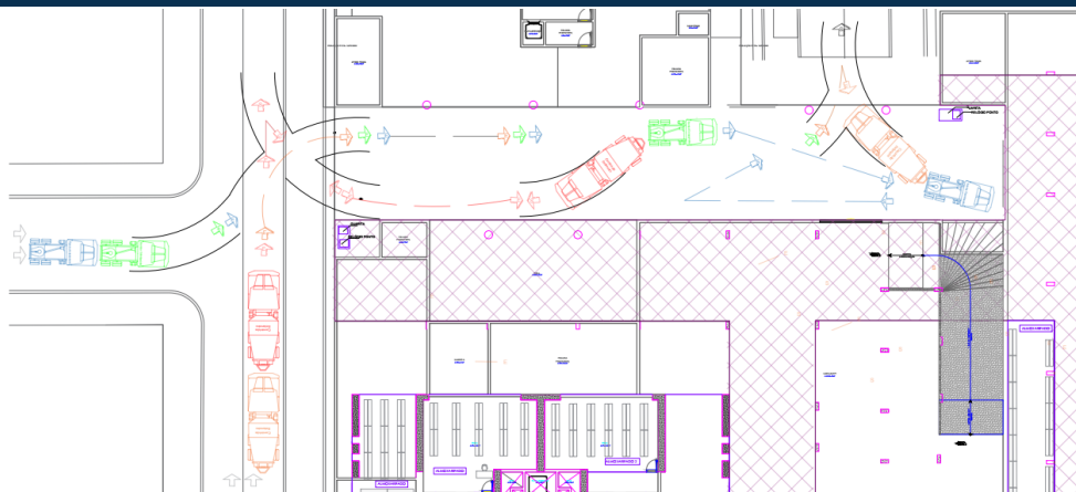
Figura 56. Detalhe para o raio de giro dos caminhões, em acordo com manual do DNIT. Fase 2 de implantação.
