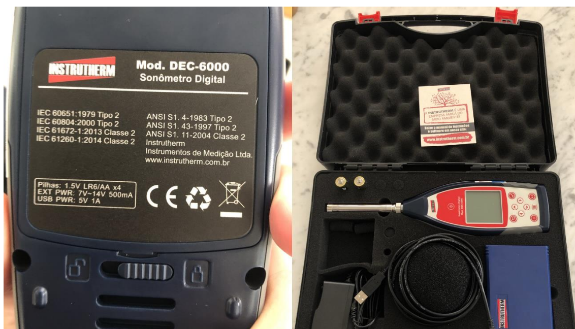
Figura 67. Sonômetro Digital DEC-6000, em atendimento as normas IEC 60651:1979, IEC 60804:2000, IEC 61672-1:2013 Classe 2 e IEC 61260-1:2014 Classe 2, ANSI S1. 4-1983 Tipo 2, ANSI S1. 43-1997 Tipo 2 e ANSI S1. 11-2004 Classe 2.
