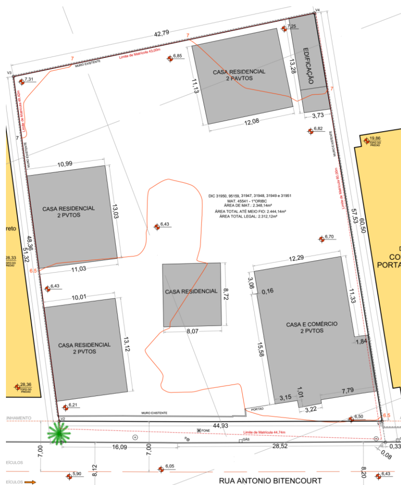
Figura 44. Levantamento planialtimétrico do terreno
