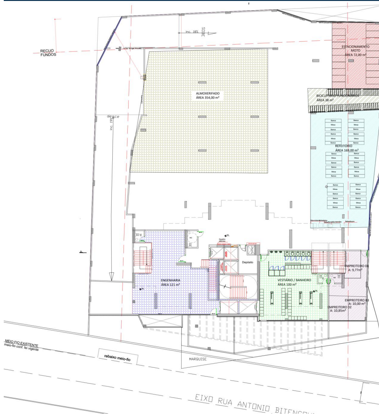
Figura 37. Projeto do canteiro de obras - EPP - 2º Pavimento - 2ª Etapa
