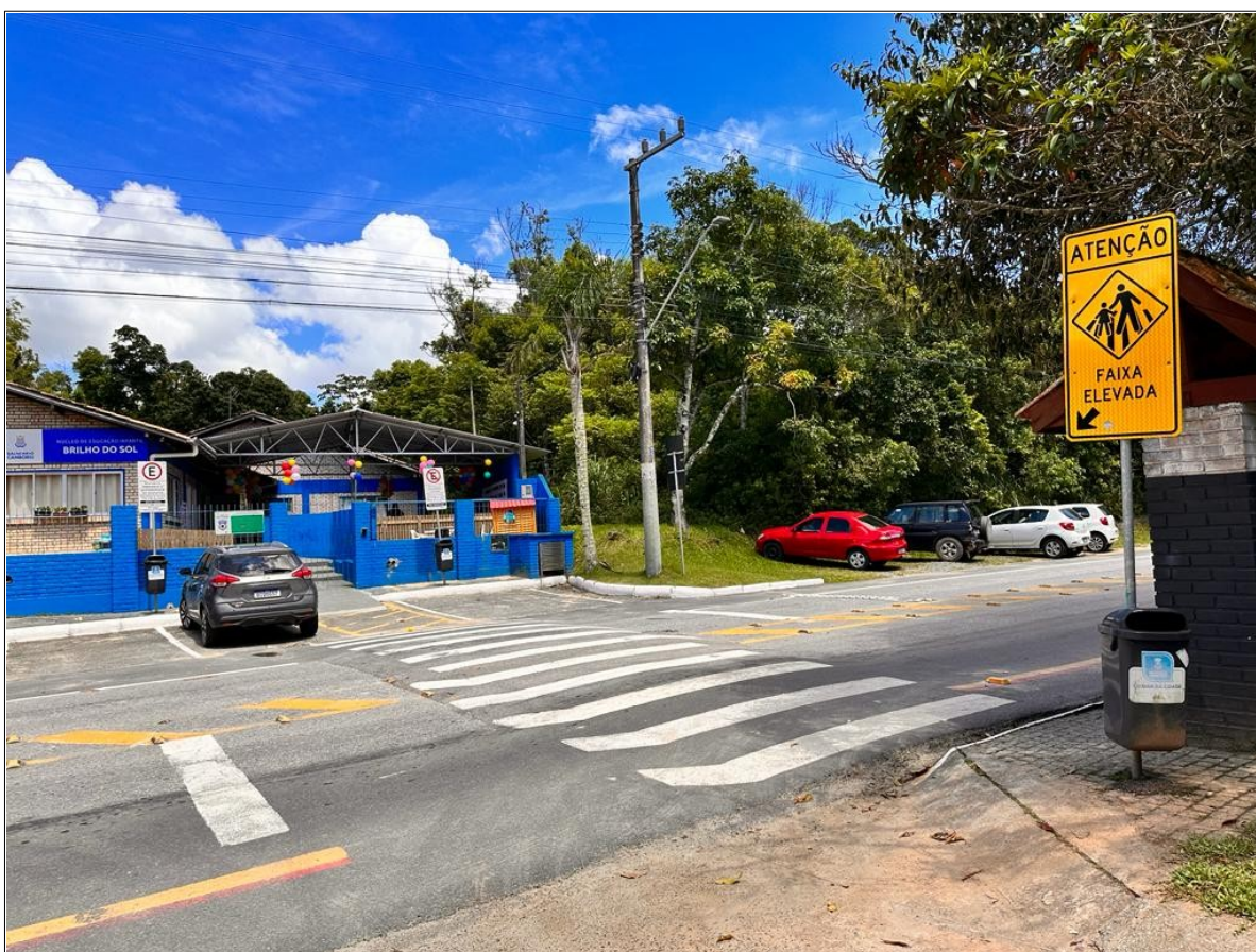
Figura 11 – Travessia desconexa da calçada e inserida na área de rebaixo do meio-fio (12/12/2023). Fonte: Autor, 2023.
