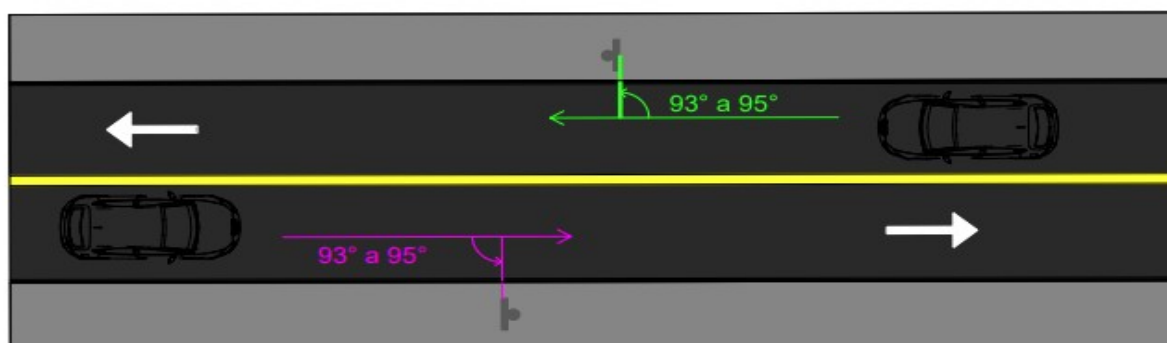
Figura 29 – Orientação das placas em relação à via. Fonte: Autor, adaptado CONTRAN, 2023.
