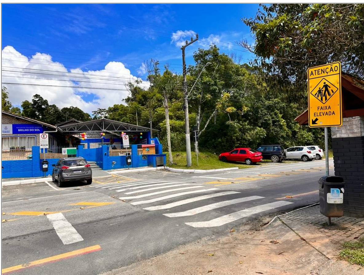
Figura 10 – Travessia desconexa da calçada e inserida na área de rebaixo do meio-fio (12/12/2023). Fonte: Autor, 2023.
