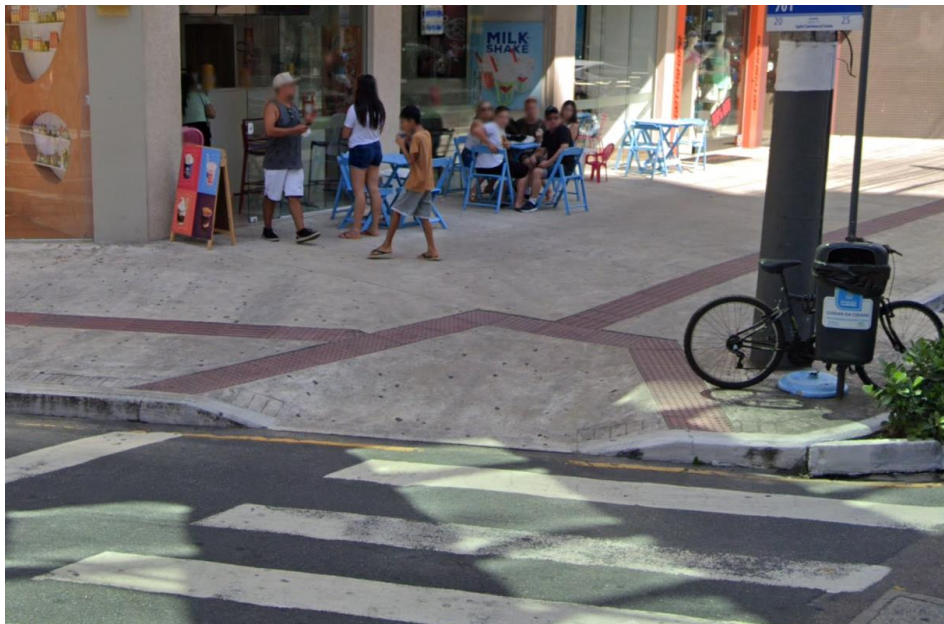
Figura 31 - Rebaixamento de acessibilidade na av. Brasil com Rua 701.
