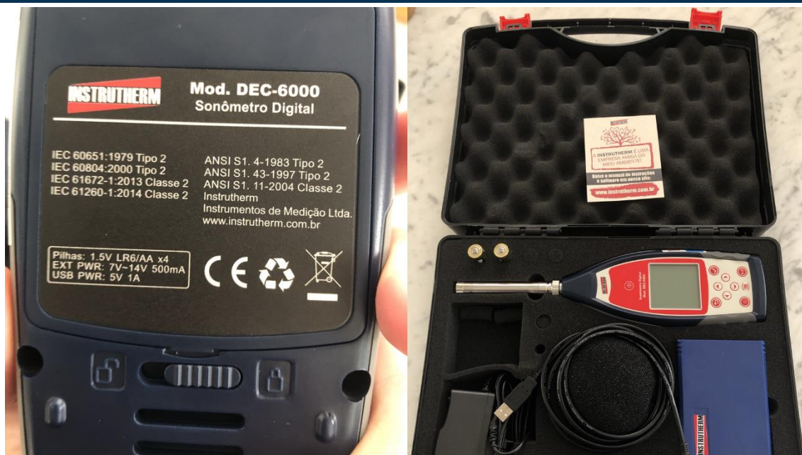
Figura 47. Sonômetro Digital DEC-6000, em atendimento as normas IEC 60651:1979, IEC 60804:2000, IEC 61672-1:2013 Classe 2 e IEC 61260-1:2014 Classe 2, ANSI S1. 4-1983 Tipo 2, ANSI S1. 43-1997 Tipo 2 e ANSI S1. 11-2004 Classe 2.
