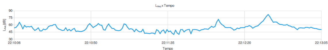
Figura 12 – Gráfico com a frequência dos níveis de pressão sonora identificados no Ponto Amostral #01 às 22h.
