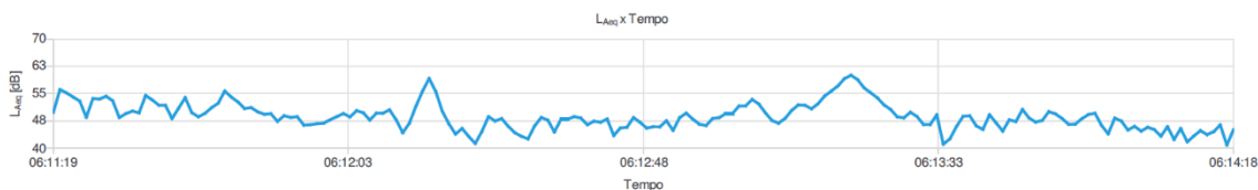
Figura 6 – Gráfico com a frequência dos níveis de pressão sonora identificados no Ponto Amostral #01 às 06h.
