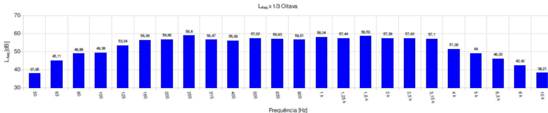
Figura 4 – Gráfico com a frequência dos níveis em banda de 1/3 de oitava identificados no Ponto Amostral #02.
