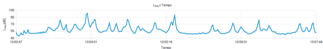
Figura 9 – Gráfico com a frequência dos níveis de pressão sonora identificados no Ponto Amostral #01 às 11h.
