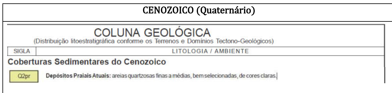
Figura 54 - Coluna Estratigráfica (formação litológica do local do empreendimento). Fonte Mapa Geológico do Estado de Santa Catarina, 2014-CPRM.
