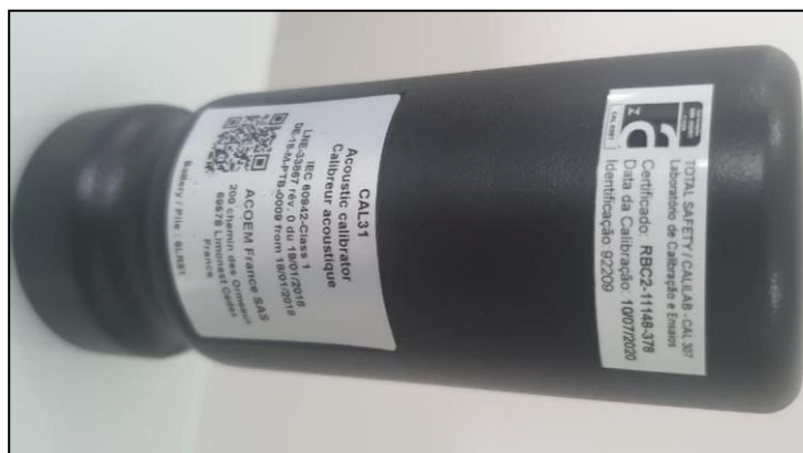
Figura 9: Calibrador acústico da marca 01dB, modelo CAL 31.
