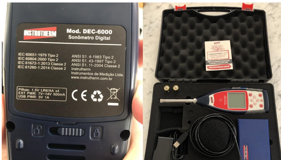
Figura 1. Sonômetro Digital DEC-6000, em atendimento as normas IEC 60651:1979, IEC 60804:2000, IEC 61672-1:2013 Classe 2 e IEC 61260-1:2014 Classe 2, ANSI S1. 4-1983 Tipo 2, ANSI S1. 43-1997 Tipo 2 e ANSI S1. 11-2004 Classe 2. Fonte: Ecolibra, 2022
