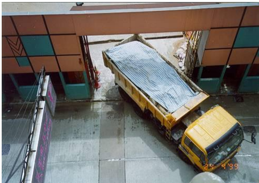
Figura 3. Caminhão com caçamba coberta para evitar dispersão de partículas
