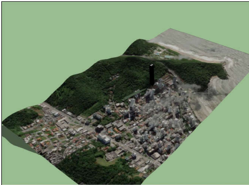
Figura 23 - Simulações de projeção de sombreamento no Solstício de Verão as 08:00 - 10:00 - 14:00 - 16:00 - 18:00 horas
