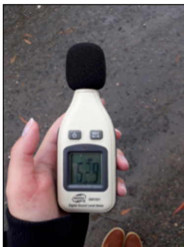
Figura 94 - Decibelímetro a cerca de 120 cm do chão e 200 cm do local
