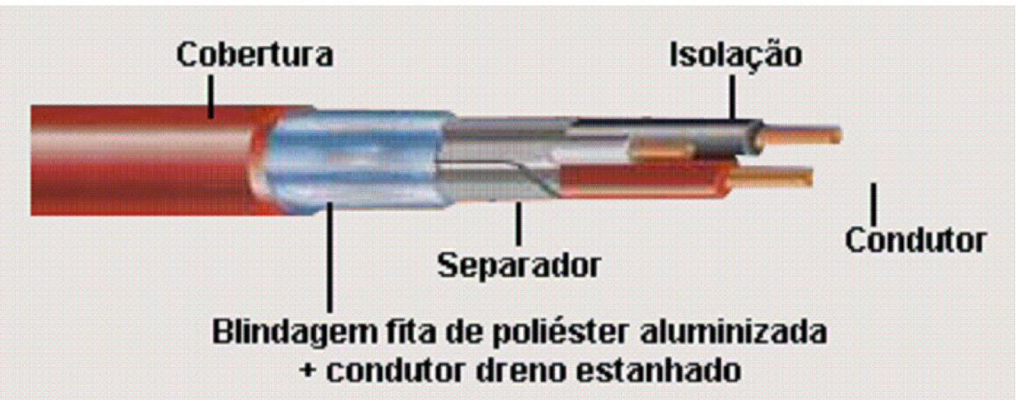
DETALHE DO CABO A SER INSTALADO NO SISTEMA DE DETECÇÃO E ALARME DE INCÊNDIO SEM ESCALA
