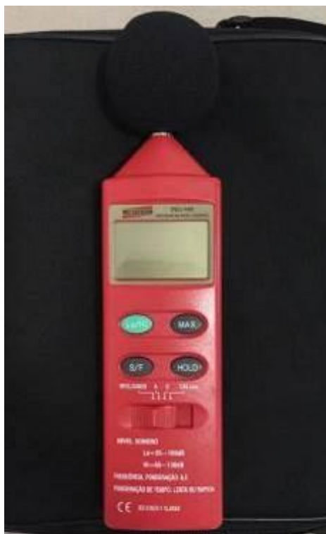
Figura 86. Decibelímetro Instrutherm, modelo DEC-460.
