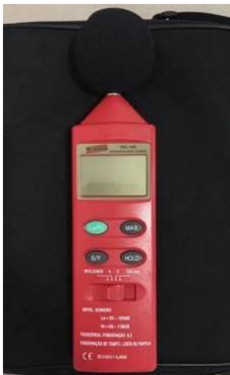
Figura 84. Decibelímetro Instrutherm, modelo DEC-460.
