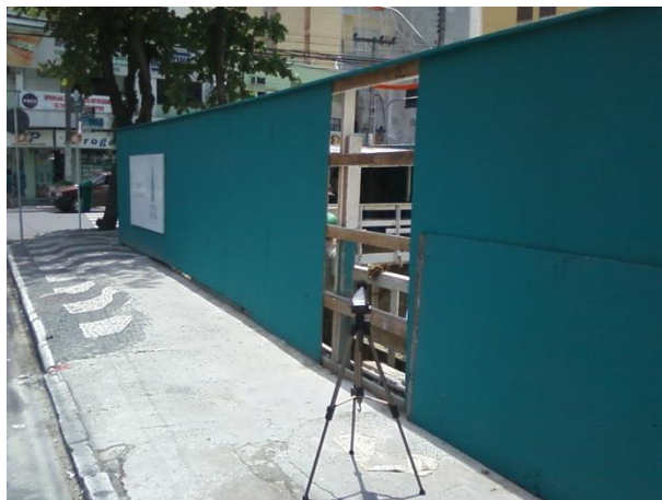
FOTO 3_ Decibelímetro instalado junto a empreendimento para medição sonora diurna na fase 1 – infraestrutura com tapume aberto e rompedor em utilização.
