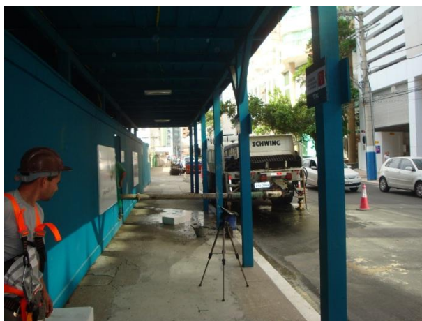
FOTO 4_ Decibelímetro instalado junto a empreendimento para medição sonora diurna na fase 2 – supraestrutura em dia de concretagem com a bomba sendo utilizada.
